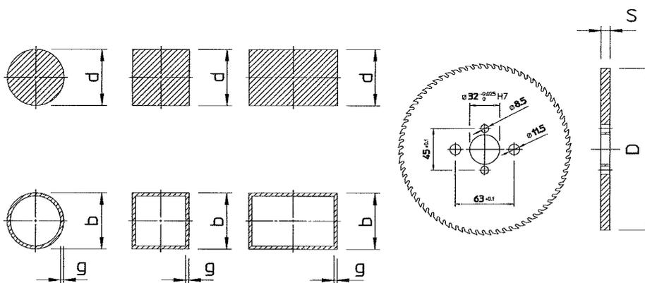
Si garantisce il funzionamento ottimale della vite-corona utilizzando dischi con fori di trascinamento.
